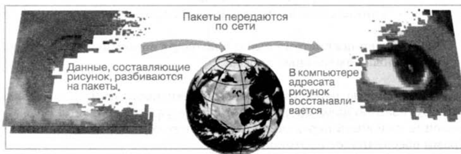
Рис. 4.5. Пакетная передача данных
