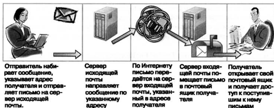
Рис. 4.6. Схема работы электронной почты
